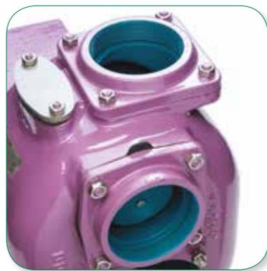
**Bocche di aspirazione e mandata** di serie sono filettate GAS (sino a 4"), a richiesta anche NPT; gli attacchi sono avvitati sul corpo per poter scollegare più facilmente le tubazioni.
