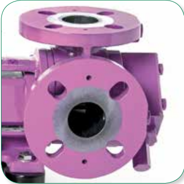
Фланцевые порты в соответствии со стандартами DIN или ANSI от DN40 до DN250, со сквозными отверстиями для облегчения установки. 1/4-дюймовые резьбовые отверстия для вакуумметра/манометра.
