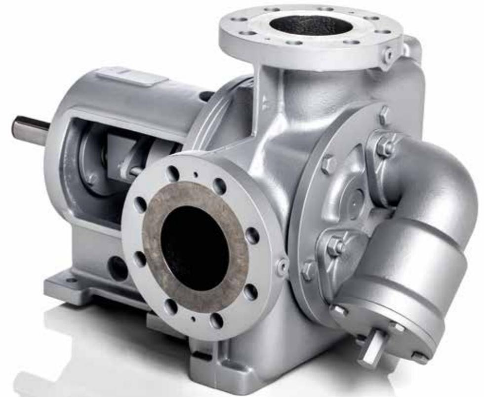
Pumpe mit Sicherheitsventil und Heizmantel um das Gehäuse, um das Bitumen auf der richtigen Temperatur zu halten. Bei langsamen Drehzahlen kann die Pumpe Bitumen auch an der Erstarrungsgrenze problemlos pumpen.
